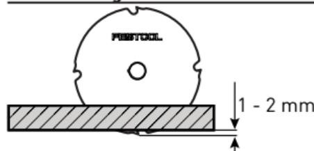
Regolare la profondità di taglio in base allo spessore del pezzo in lavorazione – sponenza denti max. 1 - 2 mm.
