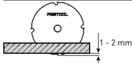
Ajustar a profundidade de corte de acordo com a espessura da peça a trabalhar – sobressaliente dos dentes 1 - 2 mm.
