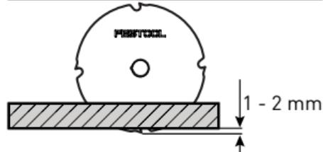
Podešavanje dubine sečenja prema debљini predmeta obrade - razmak zubaca 1 - 2 mm.
