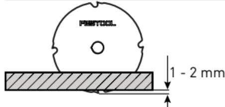
Отрегулируйте глубину реза под толщину заготовки — пила должна выступать над заготовкой на 1—2 мм.
