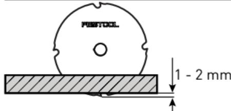
Ustawianie głębokości cięcia zgodnie z grubością elementu obrabianego – wystawianie zębów 1 - 2 mm.
