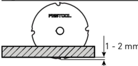
Noregulējiet zāgēšanas dzīlumu atbilstoši sagataves biezumam – zobu izvirzījums ir 1 - 2 mm.
