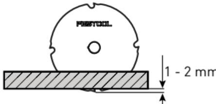
Ajustar la profundidad de corte según el espesor de la pieza de trabajo; rebase de diente de 1-2 mm.
