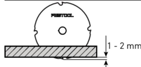
Régler la profondeur de coupe selon l'épaisseur de la pièce – dépassement des dents 1 - 2 mm.
