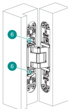
**Andruckverstellung / Depth adjustment / Réglage de la compression de joint / Ajuste de profundidad:**
