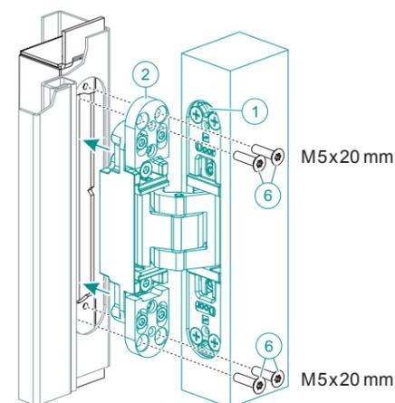
**DE** Die Stahlzarge muss mit TE 340 3D SZ ausgestattet sein. Das Band-Rahmenteil ② mit den 4 Schrauben ⑥ an TE 340 3D SZ befestigen (8 Nm).
