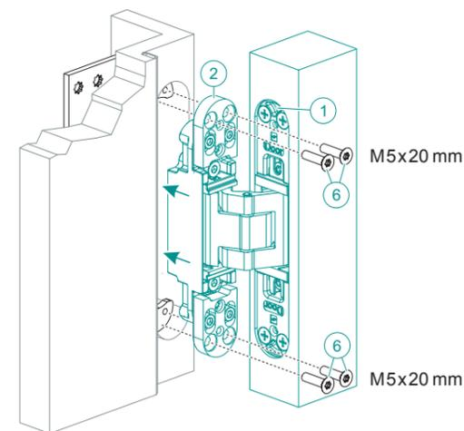
**DE** TE 340 3D FZ rückseitig an der Zarge verschrauben. Je nach Zargenkonstruktion beiliegende Distanzplättchen verwenden. Das Band-Rahmenteil ② mit den 4 Schrauben ⑥ an TE 340 3D FZ befestigen (8 Nm).
