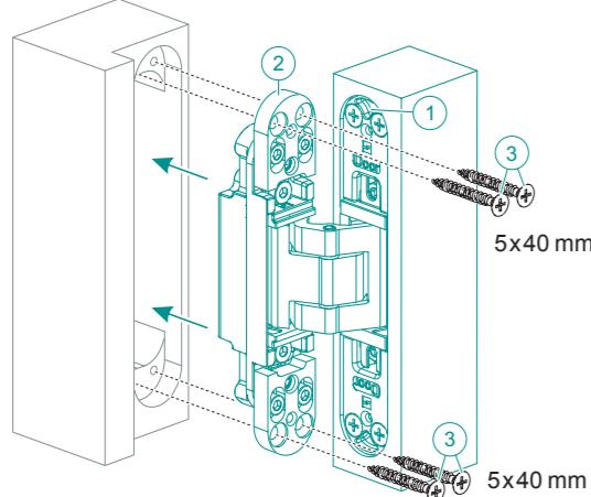
**DE** Das Band-Rahmenteil (2) in die Zarge einsetzen, die Zarge vorbohren und das Band-Rahmenteil mit den 4 Schrauben (3) befestigen.
