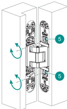
Seitenverstellung / Side adjustment / Réglage latéral / Ajuste lateral:
