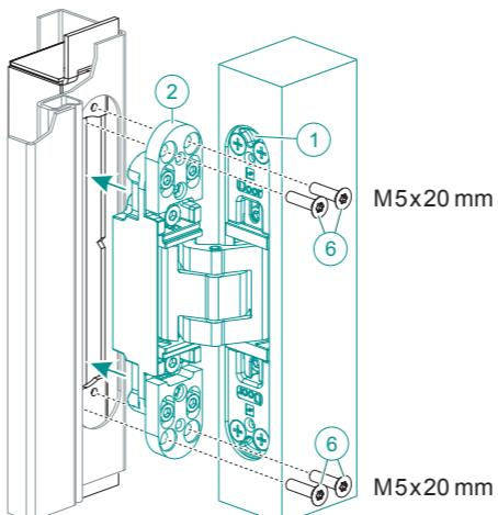
**DE** Die Stahlzarge muss mit TE 340 3D SZ ausgestattet sein. Das Band-Rahmenteil (2) mit den 4 Schrauben (6) an TE 340 3D SZ befestigen (8 Nm).
