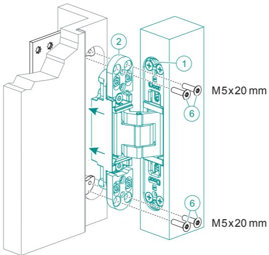
**DE** TE 340 3D FZ rückseitig an der Zarge verschrauben. Je nach Zargenkonstruktion beiliegende Distanzplättchen verwenden. Das Band-Rahmenteil (2) mit den 4 Schrauben (6) an TE 340 3D FZ befestigen (8 Nm).
