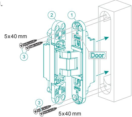
**DE** Das Band-Flügelteil (1) in den Türflügel einsetzen, den Türflügel vorbohren und das Band-Flügelteil mit den 4 Schrauben (3) befestigen.
